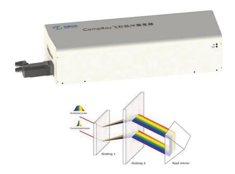
CompRay提供负啁啾的飞秒激光脉冲压缩器或展宽器,采用高透过率光栅,实现超过50%的压缩效率;采用高密度光栅,提供25ps/nm的超大色散量;采用精密电控调节平台,实现宽范围脉冲宽度的调谐,是飞秒激光强有力的时间整形工具。
